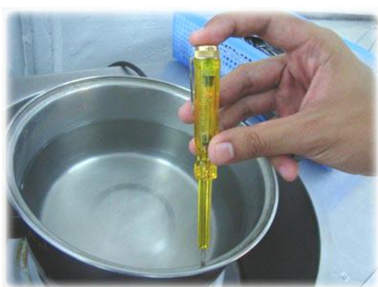
รูปที่ 1.9 การใช้ไขควงลองไฟทดสอบไฟรั่ว
